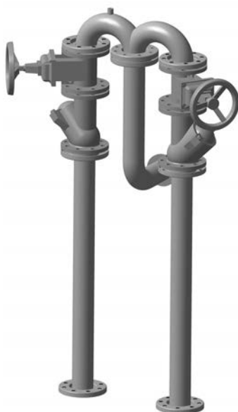
Рис. 6 GC, обвязка с S-образным коленом
