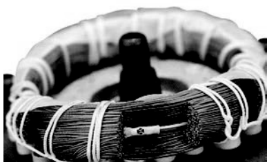
Рис. 26 Датчик РТС, встроенный в обмотку
