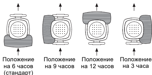
Рис. 30 Возможные положения клеммной коробки
