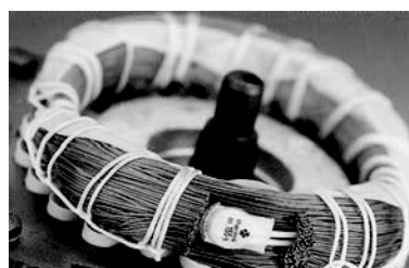
Рис. 28 Термовыключатель, встроенный в обмотку электродвигателя
